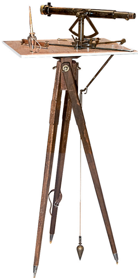
Messtisch, bestehend aus abnehmbarer Platte und Stativ um 1850, mit Zubehör Bayerische Vermessungsverwaltung
